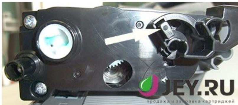
с картриджами с ограниченным ресурсом использования. Основное отличие стартовых картриджей от стандартных, это отсутствие флажка сброса тонера. На верхней картинке стандартный картридж. Стрелочкой на нем обозначен флажок сброса тонера. На картинке ниже, стартовый картридж без флажка сброса тонера.
